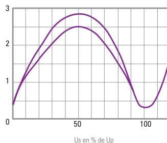
Caídas de tensión en el secundario  $U_s$  según la tensión de alimentación  $U_p$ .
