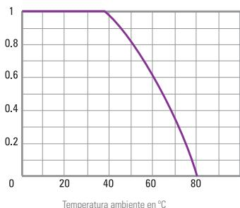
Si se sobrepasan los 40°C, la corriente nominal  $I_n$  resultará afectada por el coeficiente  $K_t$ .
